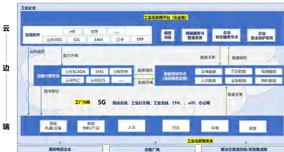
图 2 5G 全连接工厂基础设施建设参考架构
